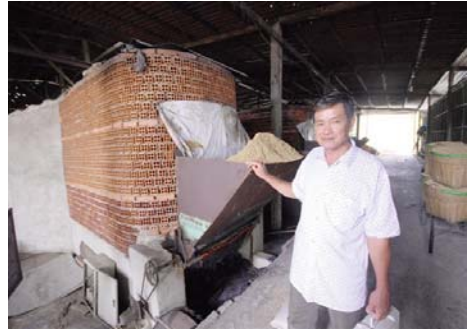
Ông Bảy Thiên bên lò sấy lúa với công suất lên 66 tấn/mẻ
